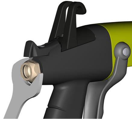
Die Pistole mit dem Lauf nach oben positionieren und die Feder und das Luftventil herausnehmen. Wenn die Teile nicht herausfallen, leicht auf der Handfläche aufstoßen
