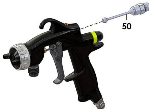
Die Schutzmutter mit dem Pistolenschlüssel abschrauben.
