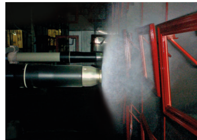
Hochrotationszerstäuber 15.000 UPM - 85 UPM unter Last
